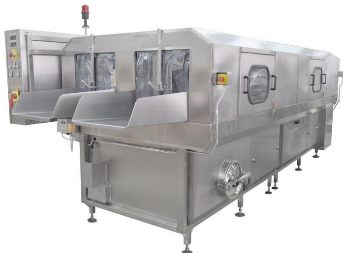
20.0159.23 – dozavimo sistema, būgninis filtras, papildomas liukas būgninio filtro valymui, apsauginiais jungikliais įmontuotais ant šoninių dangtelių, signalinė lemputė, papildomi kanalai, bendras vandens kanalas pirminiam ir bendram valymui, vandens padavimas iš valymo rezervuaro į pirminį valymą
