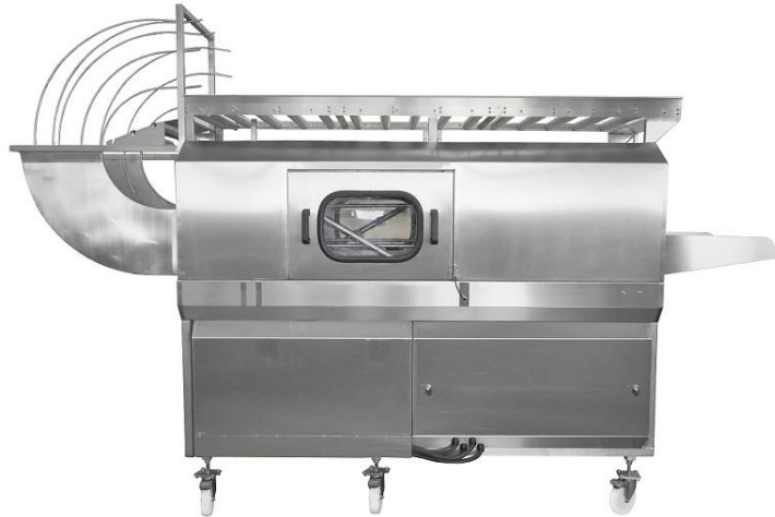
20.0002.27 – iki 240 dėžių, ant ratų; valdymo pultas – sieninis montavimas; dviejų pakopų šildymas
